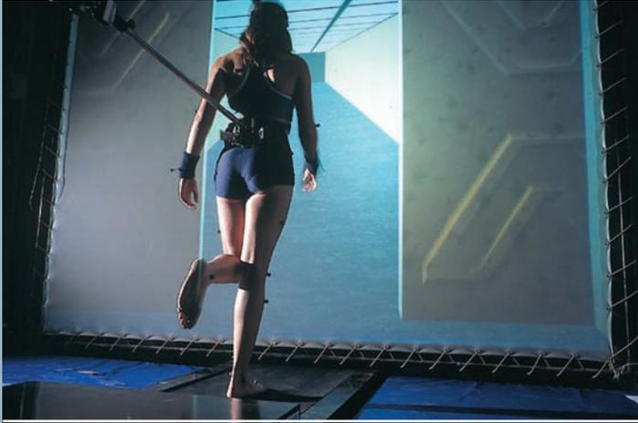
*Sport et réalité s'associent au service de la performance : tapis roulant associé à un système de réalité virtuelle pour l'analyse du contrôle visuo-guidé de la marche. Le sujet contrôle directement la vitesse de marche grâce à un capteur de force. Le défilement de la scène virtuelle est couplé à la vitesse du tapis.
